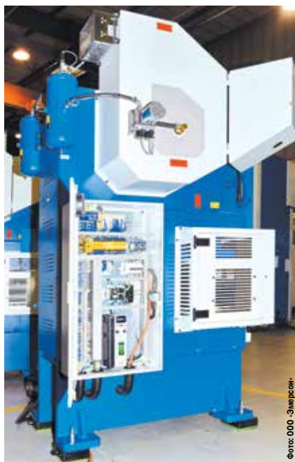
Control Techniques Unidrive M701 на штамповочном прессе
